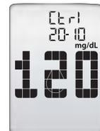
Confrontare il risultato del test della soluzione di controllo con l'intervallo stampato sull'etichetta del flacone di strisce reattive BGStar™ per la concentrazione della soluzione di controllo Normale. Il risultato della soluzione di controllo dovrebbe rientrare in questo intervallo. Il risultato del test della soluzione di controllo viene salvato in memoria.
