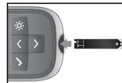
**[2] Strumento pronto per il test:** lo strumento ora visualizza il simbolo di una goccia. È ora possibile inserire la soluzione di controllo all'interno del sistema BGStar™. Non è necessario impostare un codice di calibratura per questo strumento.
