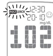
È possibile cambiare questa impostazione in un secondo momento premendo i tasti freccia BASSO (▼) o ALTO (▲), a condizione che la striscia reattiva non sia ancora stata rimossa dallo strumento.
