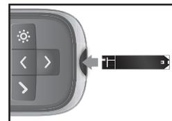
*Nota: se il test non viene avviato entro 5 minuti, lo strumento verrà disattivato. Per riattivare lo strumento, premere il pulsante CONFERMA (✓) o rimuovere la striscia reattiva BGStar™ inutilizzata e reinserirla nello strumento.*
