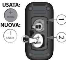
**[4] Chiudere il vano batterie:** inserire lo sportello del vano batterie nello strumento in posizione inclinata e ruotarlo verso il basso finché non scatta delicatamente
